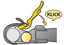
Schließen Sie den Feststellhebel um das DeFender™ iGlow an der Sattelstütze zu befestigen.
