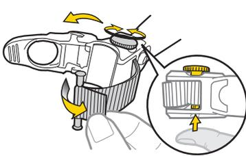
Lösen Sie den Feststellhebel und den Gurtbolzen.
