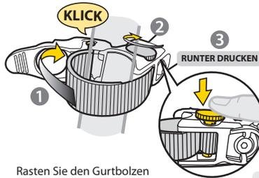
Rasten Sie den Gurtbolzen am Feststellhebel ein, bis ein „Klick“ ertönt.
